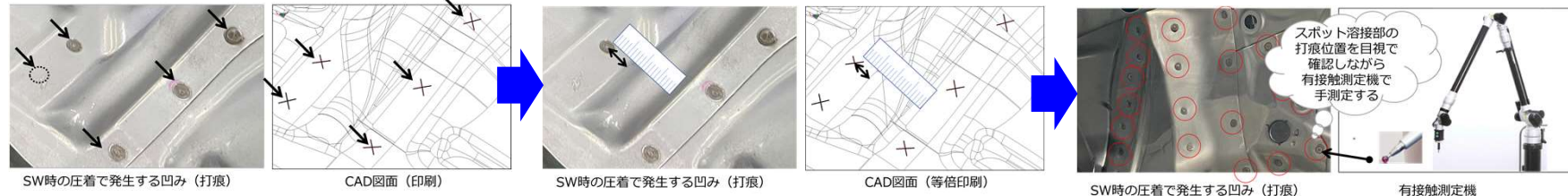
図1 目視検査：打痕の有無を目視で確認
