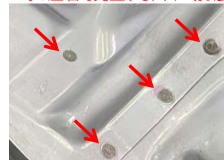
SW時の圧着で発生する凹み（打痕）
