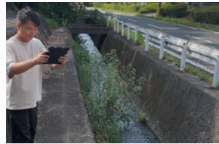
① iPadでLiDAR測定(画像、動画)
