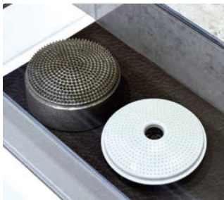
散水ノズルのシャワースクリーン部品用金型
